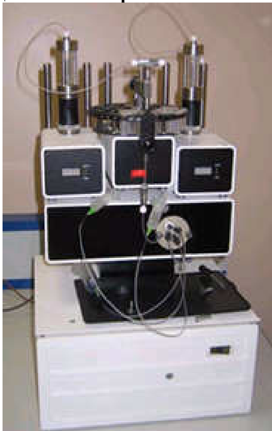
Общий вид хроматографа жидкостного микроколоночного МИЛИХРОМ-5-3
